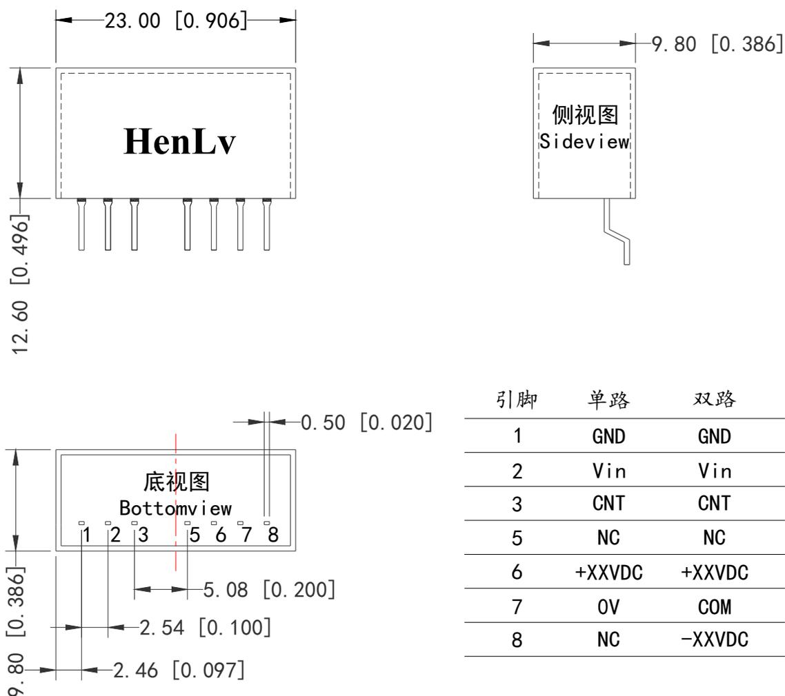
注：本公司为客户定做任意输入输出的模块电源，如有特殊需求请致电我公司处，除另有规定外，输入=Vi,模块电源的特性应符合表1的规定，且适用于全温范围(-40°C ≤ Tc ≤ 85°C)
